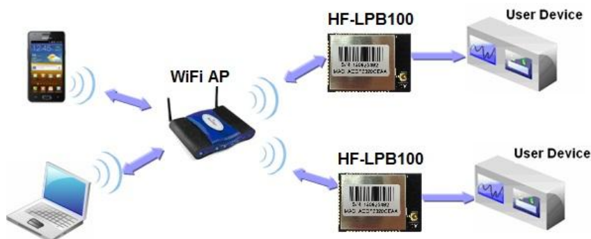
Figure 9. 基本的 HF-LPB100 无线组网结构
